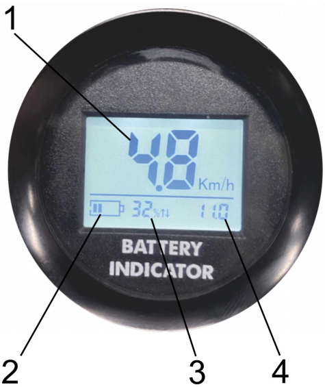
图 11-2 圆形电量表（锂电池）
